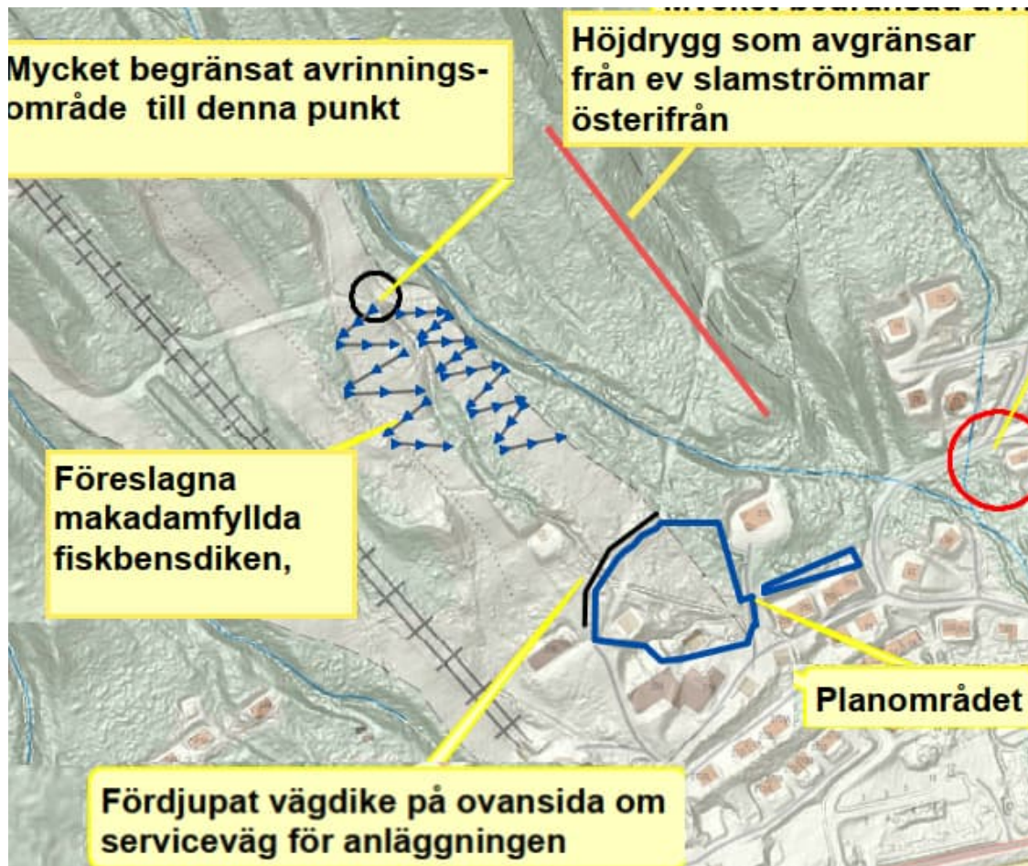
Figur 34. Översiktsillustration på förslagna åtgärder.
