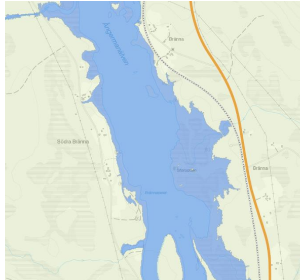
Vattenflödets utbredning vid 100-årsflöde längs Ångermanälven och väg E45 (med transporter av farligt gods) nedströms Volgsjön, vid Volgsjöfors och Södra Bränna.
